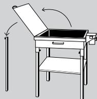
Abrimos la plancha hacia un lado y la apoyamos sobre la pata adicional que está junto a las llaves
